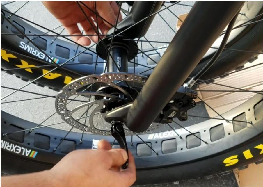
**WARNING: MAKE SURE TO TIGHTEN THE QUICK-RELEASE IN THE FORK SO THAT THE WHEEL CANNOT FALL OUT OF THE FORK; FAILURE TO ADEQUATELY TIGHTEN THE QUICK-RELEASE CAN RESULT IN ACCIDENTAL RIDER INJURY OR DEATH.**
