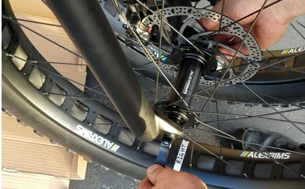
**WARNING: MAKE SURE TO TIGHTEN THE QUICK-RELEASE IN THE FORK SO THAT THE WHEEL CANNOT FALL OUT OF THE FORK; FAILURE TO ADEQUATELY TIGHTEN THE QUICK-RELEASE CAN RESULT IN ACCIDENTAL RIDER INJURY OR DEATH.**
